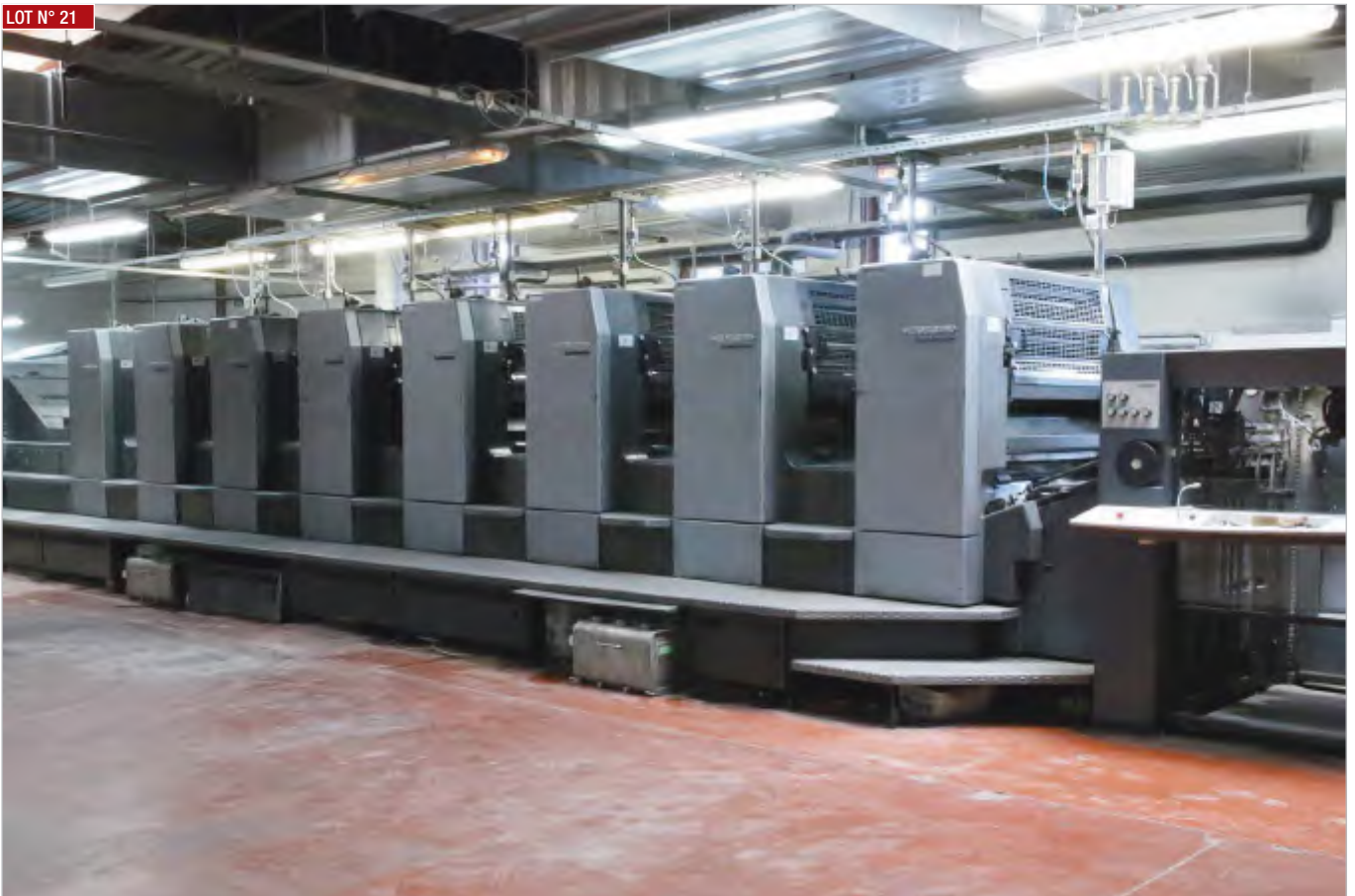
► Presse offset HEIDELBERG 8 couleurs, 72 X102 cm, mod. SPEEDMASTER, type SM102-8-P5-S (2001)
