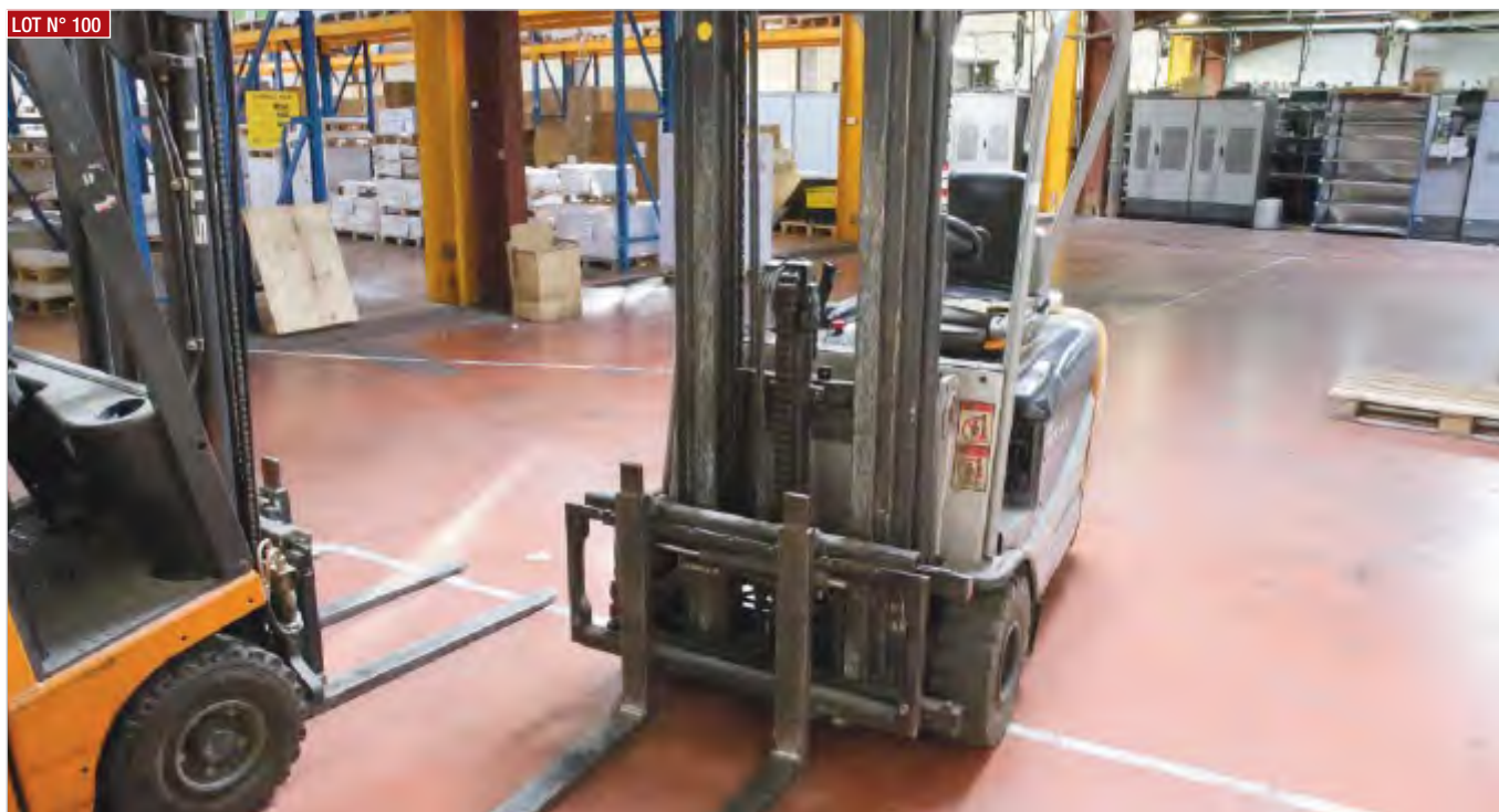
► Chariot élévateur électrique STILL , type RX50-15, mât triplex ht maxi 4 m, cap 1,5 T ► STILL Electrical forklift, type RX50-15, triplex mast, max Ht 4 m, cap 1.5T
